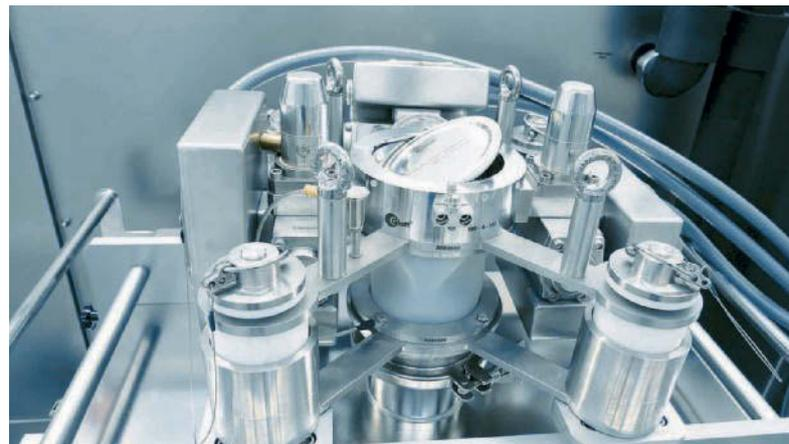
Die Produktion unter Containment erlaubt es dem Personal, ohne Schutzanzüge zu arbeiten. Bild: Glatt
